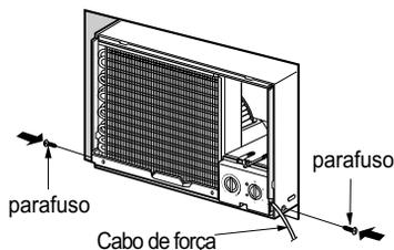
**⚠ ATENÇÃO:** O cabo de força deve estar conectado a um circuito independente. O fio verde deve estar conectado a terra.
